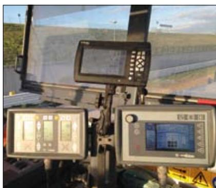
Il Control Box CB460 di Trimble installato sulla fresa indica la posizione del tamburo rispetto al progetto 3D o alla compensazione verticale predefinita
